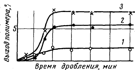
Рис. 15. Зависимость выхода полимера от времени измельчения: 1 — неэкстрагируемый полистирол; 2 — экстрагируемый полистирол; 3 — общее количество полистирола. По 42 .
